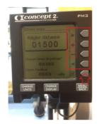
5- "Prêt à ramer" si affichage différent appuyer sur "change units" pour passer de calories à mètres ou "change display" si présentation écran différente.
